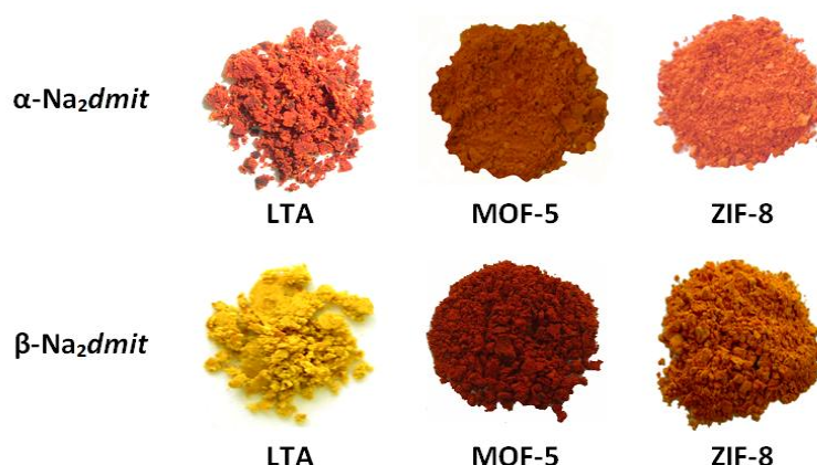
Rys. 6. Przykładowe barwy kompleksów otrzymanych na bazie sit molekularnych impregnowanych roztworem Na_2dmit .
